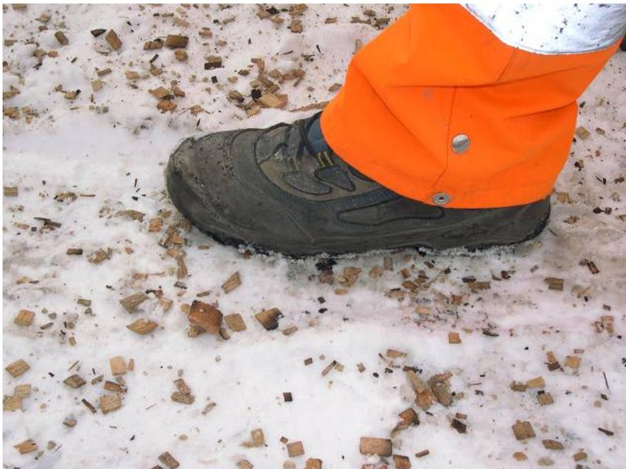
**Photo 2 - Aspect d'une surface avec un dosage en copeaux correct**
