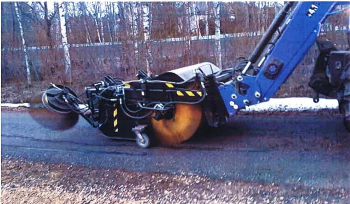
Photo 21 : brossage en action. Bon fonctionnement avec 1 passage. Résultat impeccable et sans poussière.
